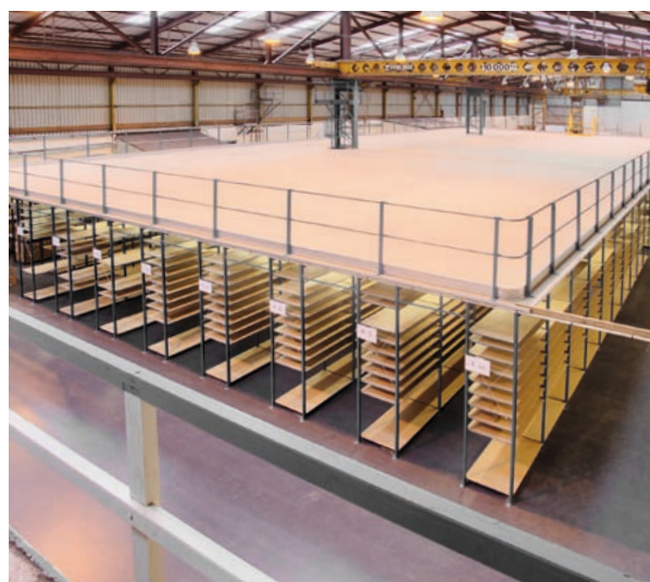
Plate-forme sur rayonnage Fliplus (version mi-lourde du Flip).
